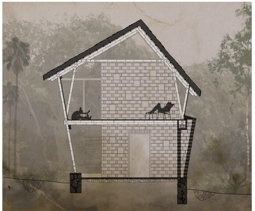
Coupe Nord/Sud. Le mur sud en brique s'incline vers l'extérieur. Durant les heures les plus chaudes, les briques créent une ombre sur les suivantes permettant avec l'épaisseur du mur et le fait qu'il soit creux de garder frais les espace intérieurs.
